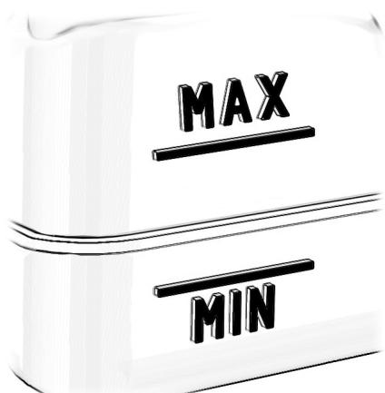
Prepričajte se, da je pri ohljenem motorju nivo hladilne tekočine med oznakama **MIN** in **MAX** na obeh posodah za hladilno tekočino, za motor in elektromotor. Če je nivo tekočine pri oznaki MIN ali pod njo, nemudoma dolijte hladilno tekočino.
